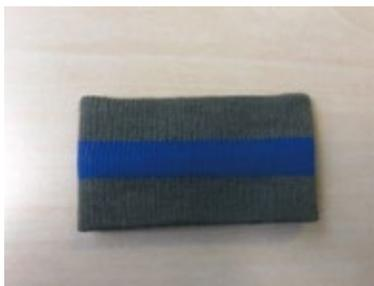
作業前、作業中にリストバンドを金属部分に当てることで、作業員が持つ静電気を空気中に放電するスグレモノです。当社スタッフはこれをつけて機器の試験、商品の取扱をしています。
